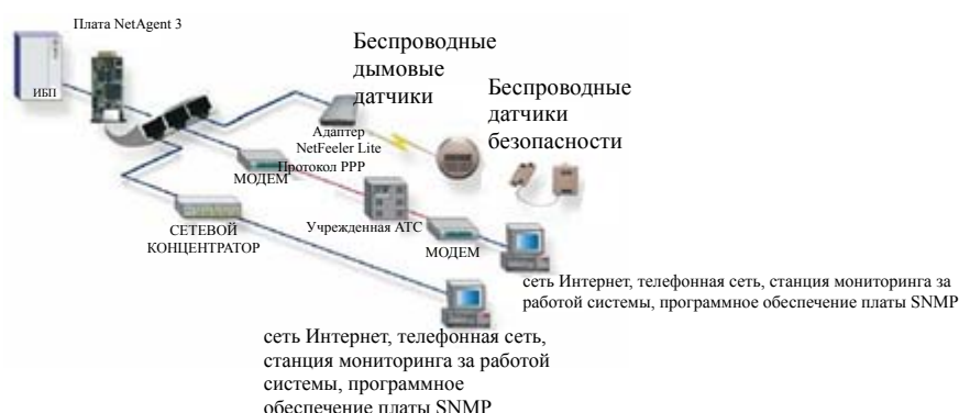
Стандартная топология сетевого управления ИБП.
