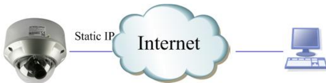
Рис.3.5.2 Подключение напрямую со статическим IP
