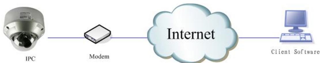
Рис.3.5.4 Подключение камеры с использованием PPPoE dial-up
