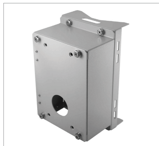
СТОЛБОВАЯ ШИРОКАЯ МОНТАЖНАЯ КОРОБКА 270x166x155 мм (10.6x6.5x6.1 дюймов); 3.2 кг (7.1 фунтов); Поставляется с М8*16 винт-4, шайба-4, эластичная шайба-4, хомут из нержавеющей стали-4.
