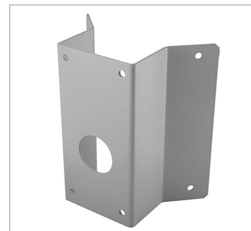
УГЛОВАЯ СТАНДАРТНАЯ КРЕПЁЖНАЯ ПЛАСТИНА 222x204x117 мм (8.7x8x4.6 дюймов); 2 кг (4.4 фунтов); Поставляется с резиновой шайбой -8x4, Эластичная шайба-4, М8*16 винт-4, М8 гайка-4.
