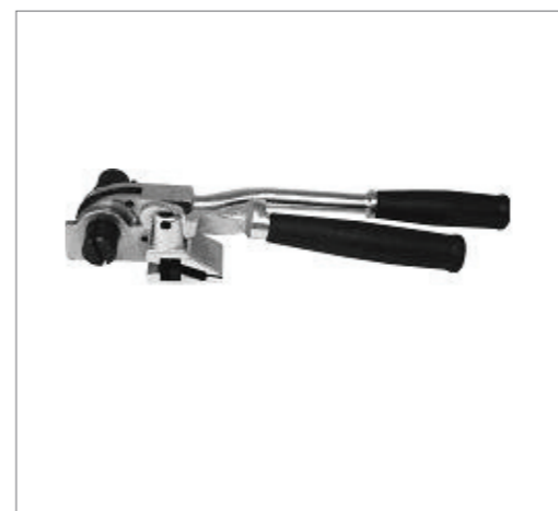
РЕЗАК ДЛЯ ХОМУТА ИЗ НЕРЖАВЕЮЩЕЙ СТАЛИ Для натяжения, резки и обжима хомута из нержавеющей стали. 1.4 кг (3.1 lbs) Подходит для лент шириной: 1/2", 5/8", 3/4"
