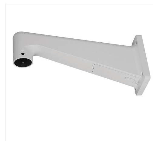
СТАНДАРТНЫЙ ПОДВЕСНОЙ КРОНШТЕЙН 348x104x138.6 мм (13.7x4.1x5.5 дюймов); 1.5 кг (3.3 фунтов); Диаметр: 45мм (1.8 дюймов). Поставляется с резиновой шайбой-8x1, Дополнительная шайба трубы-1, Эластичная шайба-8x1 и М8*12 винт-1.
